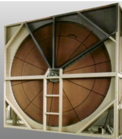
Figura 2 - Il cuore del rotoconcentratore è costituito da un tamburo rotante che contiene una grande quantità di materiale adsorbente (zeoliti)
